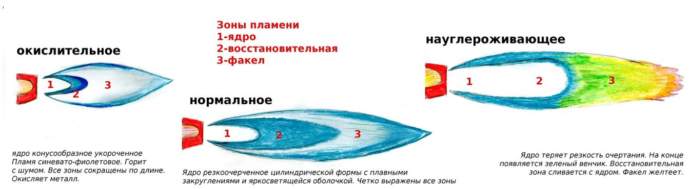
**Положение нейтрального пламени** между науглероживающим и окислительным. Науглероживающее пламя характерно неполным сгоранием рабочего газа которое проявляется удлиненным факелом и почти отсутствующей границей между ядром и восстановительной зоной. Окислительное пламя характерно укороченными зонами ядра и факела окрашенным в сине-белый цвет а также шумом исходящим от пламени.
